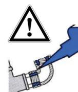
4. Prelubricar el punto de lubricación, todas las conexiones y tubos flexibles.
