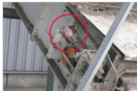
Lubrification d'un palier de pivotement
