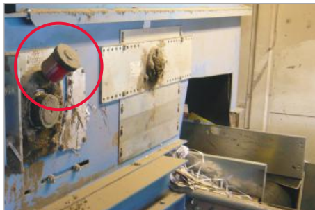
Lubrification du palier de pivotement d'un convoyeur
