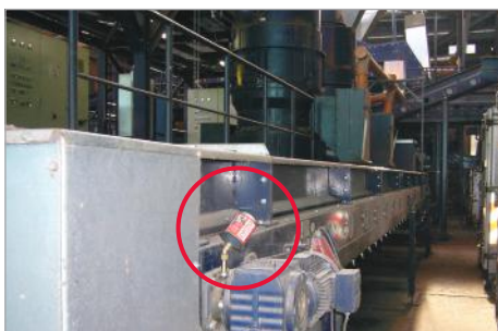
Lubrification du palier de pivotement d'un convoyeur
