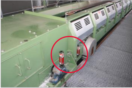
Lubrification du palier à chapeau d'un convoyeur
