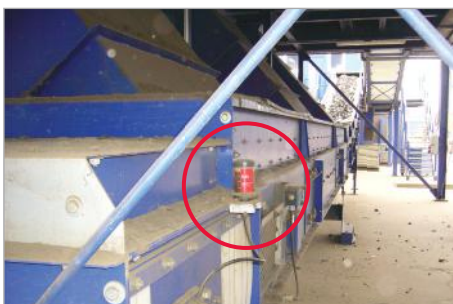
Lubrification du palier à chapeau d'un convoyeur
